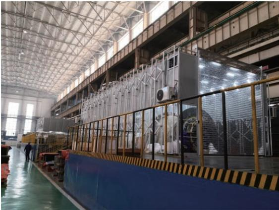
電機公司採用過封閉式過濾吸附二級級完成下線中頻焊煙塵廢氣污染治理，實現了廢氣達標排放，保護了區域大氣環境質量。
